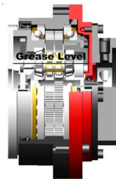
수평설치 [ Horizontal Installation ]
